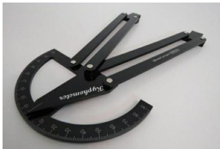
شکل ۱: کایفومتر (کایفومتر مورد استفاده جهت اندازه‌گیری زاویه کایفوزیس با دقت اندازه‌گیری ۱ درجه)
