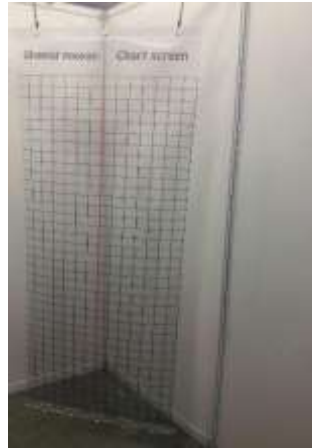
شکل ۲: صفحه شطرنجی (صفحه شطرنجی جهت غربالگری کیفی ناهنجاری کایفوزیس با ابعاد ۲۰۰×۱۰۰ سانتی‌متر و دقت اندازه‌گیری یک سانتی‌متر)
